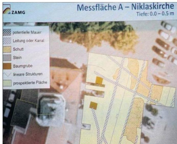
Bodenradar im Einsatz: Vermessen wurde ein Abschnitt des Hauptplatzes östlich des Kirchturms (gelb unterlegtes Feld im Bild).
