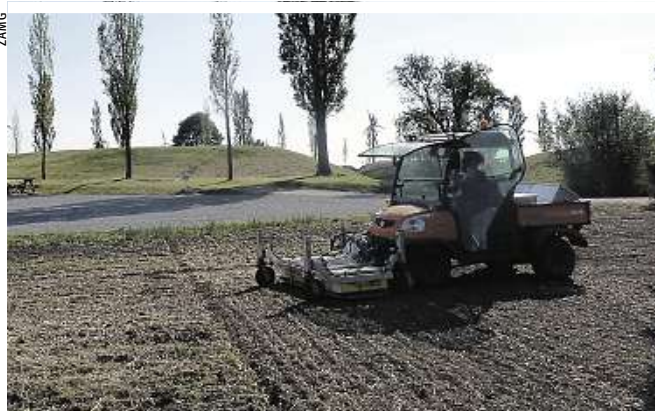
Traktor mit Bodenradar bei einer Messfahrt in Carnuntum
