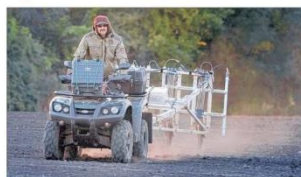
Mit dem Magnetometer können zerstörungsfrei Artefakte und Spuren der Vergangenheit im Boden sichtbar gemacht werden. Foto: LBI ArchPro, Geert Verhoeven
